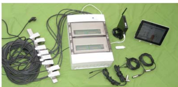
4 Kanal Messkopf mit Internetverbindung & Ipad
